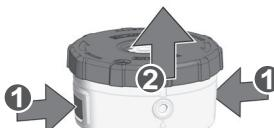
丢弃所有残留的短切割线。将保护盖重新安装回割草机机头。
