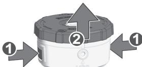
丟棄所有殘留的短的修剪線。將護蓋卡回到修整器的頭上。
